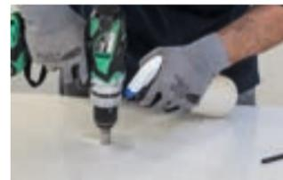
**IT 3\_** Mantenere il trapano/avvitatore ad un angolo di 90° e con una pressione delicata e costante effettuare movimenti circolari con un angolo di circa 5°-10°. Non spingere il trapano/avvitatore dritto verso il basso e accertarsi di avere acqua a sufficienza per bagnare la fresa durante tutta la lavorazione.
