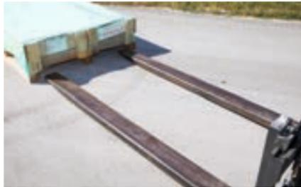
**IT** Per movimentare correttamente il pallet sul lato corto (ad esempio nello scarico dei containers) è raccomandato l'utilizzo di forche lunghe almeno 2,5 mt, questo garantisce una perfetta presa e sicurezza del materiale.
